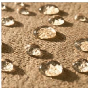
Das Prinzip gleicht einer guten Funktionsjacke: Nässe von außen gelangt nicht in die Konstruktion und Feuchtigkeit von innen wird schnell nach außen abgeführt.
